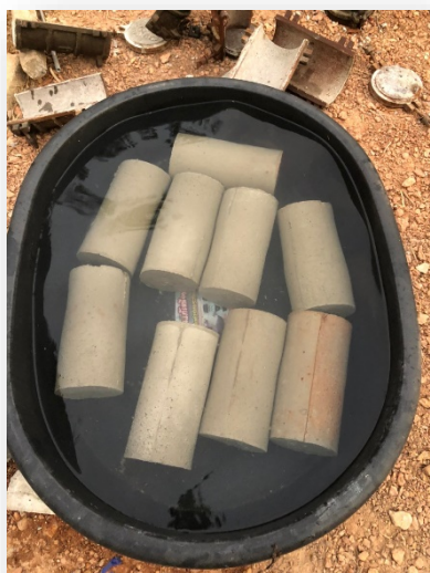
ภาพที่ 3.4 นำคอนกรีตไปบ่มตามกำหนดเวลา
