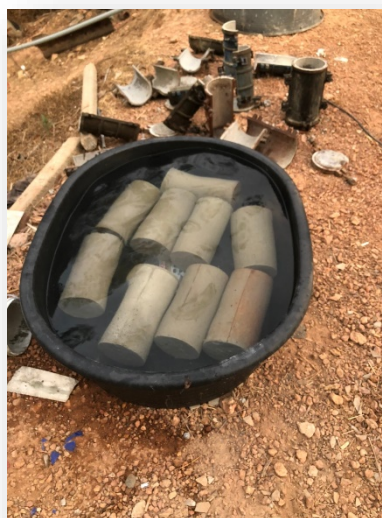
ภาพที่ 3.4 นำคอนกรีตไปบ่มตามกำหนดเวลา
