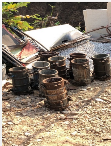
ภาพที่ 3.2 แบบหล่อคอนกรีตที่เคลือบด้วยน้ำมัน
